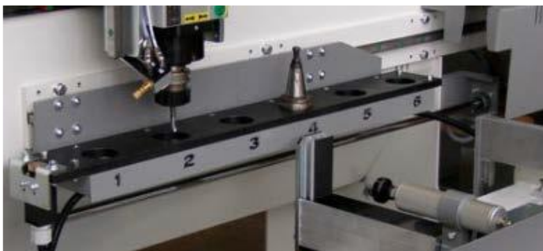
Cambio utensili automatico a 6 posizioni (optional)
